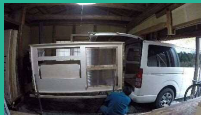
3.ジャッキで高さ調整します
